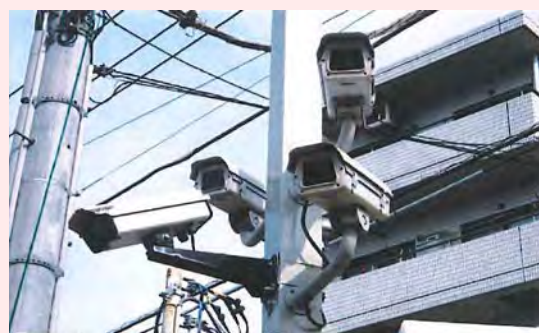
OMS: 顧客の車両ナンバープレートをカメラで撮影しデータ化、顧客カルテ情報と照合し、その内容をタブレット端末に表示。
